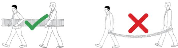
Соблюдайте правила переноски радиаторов, габариты которых превышают 1000 мм, для безопасной транспортировки к месту монтажа.
